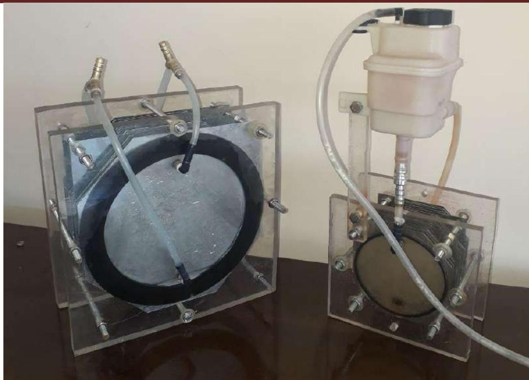
2-расм. Институтда ясалган электролизёрлар: а - трактор ва юк автомобиллари учун;
