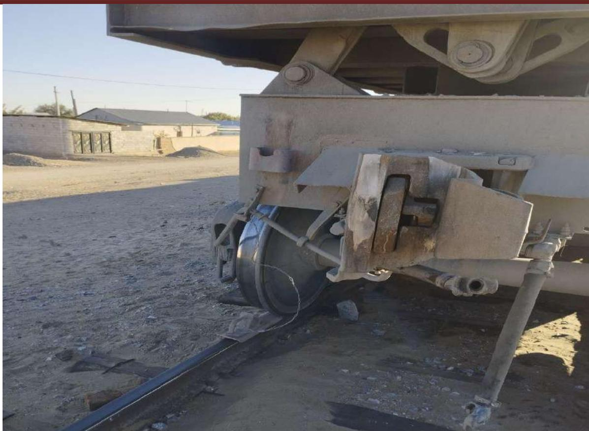
Рисунок 2. Фрагмент использования устройства для крепления тормозных башмаков на практике
