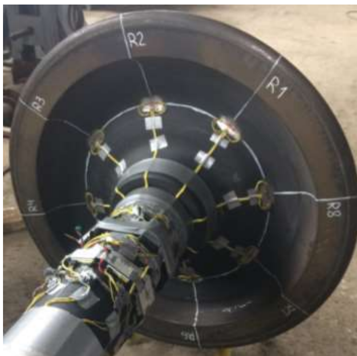
Рисунок 2. Схема работы тензометра
