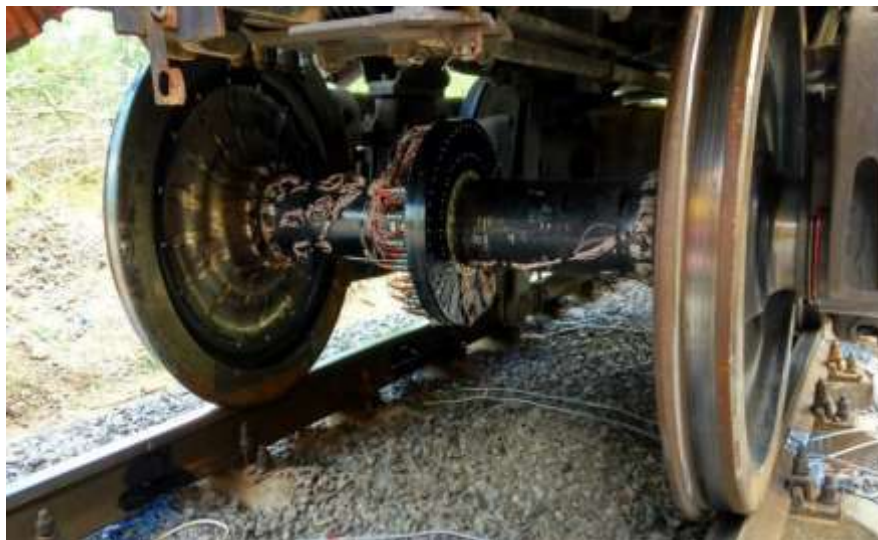
Рисунок 3. ТКП под испытываемым вагоном
